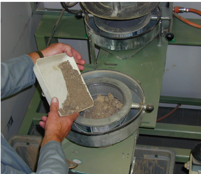
Abbildung 3 | Vorbereitung der Bodenproben für die Laboranalysen: Sieb mit 2 mm Maschenweite zur Trennung von Skelett und Feinerde (Foto: René Flisch, Agroscope).
