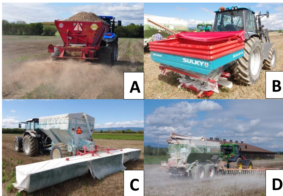
Abbildung 4 : (A) Une chaux des gravières peut être appliquée avec une épandeuse à disque spécialisée. (B) L'épandage à l'aide d'un semoir à engrais pour la chaux sous forme de granulés. (C) Chaux d'Aarberg épandue à l'aide d'une rampe spécialisée additionnée d'une bâche de protection afin de diminuer la poussière. (D) L'épandeuse à rampe spécialisée avec pendillard permet d'appliquer les produits en poudre au plus près du sol afin de limiter les pertes.
